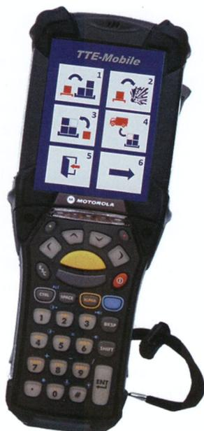
Bild 4. MDE mit intuitiv zu bedienender Software (TTE-Europe GmbH)
